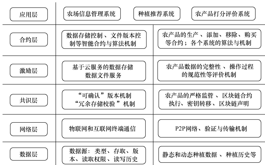
图4 基于区块链技术的种植端系统架构
